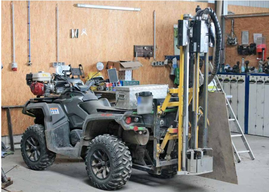
Die Maschinengemeinschaft nutzt ein Quad, um GPS-gestützt Bodenproben durchzuführen. Die Beprobung erfolgt auf Grundlage der Talking Fields (TF) Karten, die Unterschiede der Biomasseverteilung innerhalb eines Schlags zeigen.
